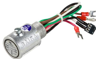
El 922.B.004.048 /EIA FASTER es un DPS del tipo limitador de tensión, compuesto por 2 etapas de protección: descargador gaseoso (Gas Discharge Tube – GDT) y varistor de óxido de zinc (Metal Oxide Varistor – MOV) con capacidad de drenaje de corrientes hasta 10 kA en la forma de onda 8/20 $\mu$ s.
