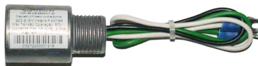
El 922.E.00 /IA FASTER es un DPS del tipo limitador de tensión, compuesto por 2 etapas de protección: varistor de óxido de zinc (Metal Oxide Varistor – MOV) y diodo de avalancha de silicio (Silicon Avalanche Diode – SAD) con capacidad de drenaje de corrientes hasta 9 kA en la forma de onda 8/20 $\mu$ s.
