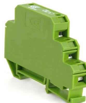
El circuito de protección es compuesto por una etapa: gaseoso (Gas Discharge Tube – GDT), con capacidad de drenaje de corriente hasta 10 kA en la forma de onda 8/20  $\mu$ s.
