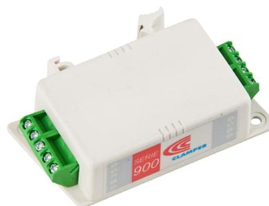
El circuito de protección es compuesto por tres etapas: gaseoso (Gas Discharge Tube – GDT), varistor de oxido de zinc (Metal Oxide Varistor – MOV) y diodo de avalancha de silicio (Silicon Avalanche Diode – SAD), con capacidad de drenaje de corriente hasta 10 kA en la forma de onda 8/20  $\mu$ s.
